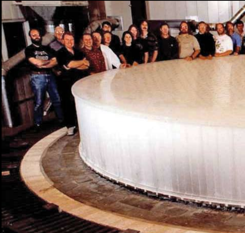
Fig. 6 Il primo specchio a nido d'ape di 8,4 m di diametro per il LBT, fotografato con lo staff che lo ha realizzato (LBTO).
