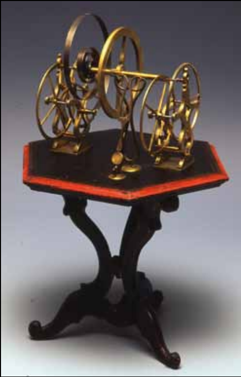
Fig. 9 Tribometro, strumento destinato allo studio dell'attrito, costruito dall'abate Nollet, metà XVIII secolo, collezione di Giovanni Poleni (Museo di Storia della Fisica, Università di Padova).
