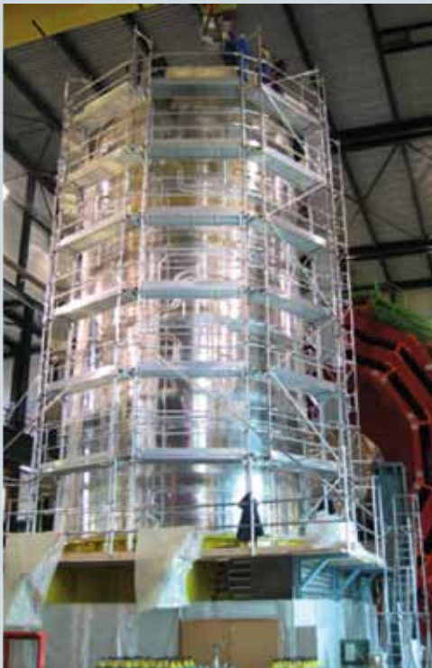
Fase di montaggio presso i laboratori del CERN di Ginevra dello schermo criogenico per il criostato elio del supermagnete CMS.
