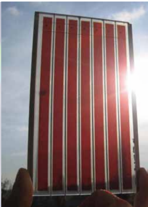
Fig. 8 Modulo DSC formato da 7 celle collegate in serie secondo lo schema di connessione "Z" (CHOSE).
