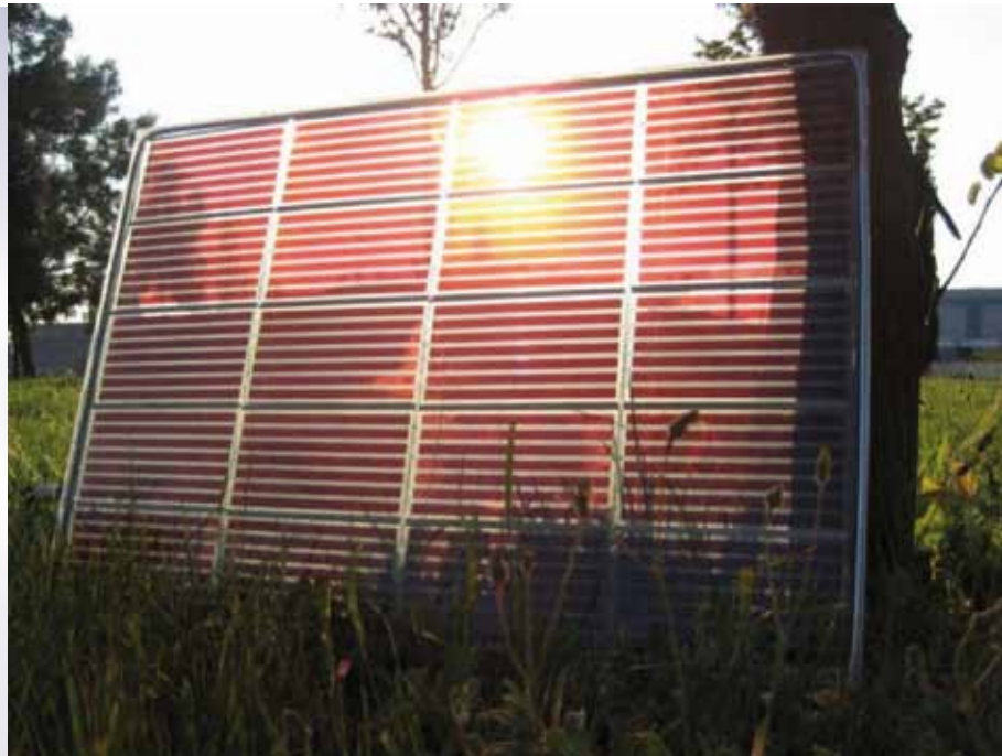
Fig. 9 Pannello DSC formato da 4 stringhe poste in parallelo. Ogni stringa è formata da 5 moduli di tipo "Z" connessi in serie (CHOSE).
