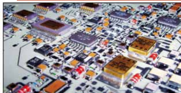
Alimentatore ad alto voltaggio per fotomoltiplicatori (rivelatori di luce in grado di individuare singoli fotoni) - CAEN AURELIA SPACE.
